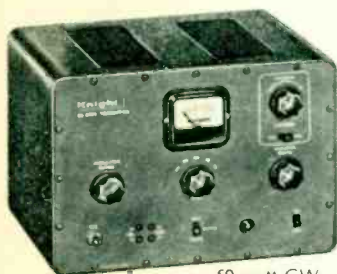
50-watt CW Transmitter
